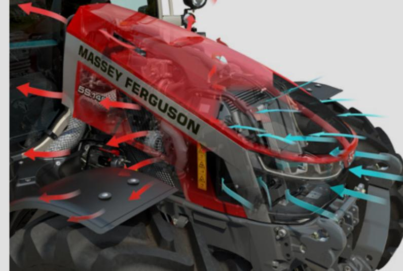
Un nouveau flux d'air permet d'améliorer le refroidissement du moteur pour plus de performance et d'efficacité. Grâce à la nouvelle calandre large, tous les radiateurs reçoivent de l'air frais, pour un refroidissement plus efficace.
